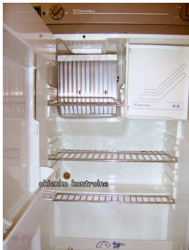
Ryc. 6. Umieszczenie okienka kontrolnego w chłodziarce.
